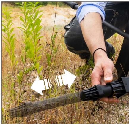
Eine der Mess-Sonden des eXp 6000 ist unsere innovative Teleskopsonde. Diese kann bis zu 124cm verlängert werden und ermöglicht auf diese Weise die Messung sehr großer Flächen in kurzer Zeit. Die Teleskopsonde ist, wie die anderen Mess-Sonden, mit einem Orientierungssensor ausgestattet, der Sie bei der Stabilisierung der Sonde während des Messvorgangs unterstützt.
