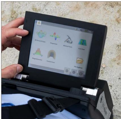
Der hochauflösende, farbige Touchscreen mit mehrsprachiger Benutzeroberfläche vereinfacht die Bedienung des professionellen 3D-Bodenscanners. Der Detektor kann zusätzlich über einen multifunktionalen Drehknopf bedient werden. Die Helligkeit des Bildschirms passt sich automatisch an die Umgebung an und zusätzlich können verschiedene Designs ausgewählt werden.
