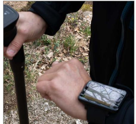
Der 3D-Bodenscanner Rover UC bietet eine schnelle und effiziente Analyse der Messdaten via Android Smartwatch. Mit intuitiven Gesten können die 3D-Grafiken des *3D Ground Scan* auf dem Display der Smartwatch gedreht und vergrößert werden.
