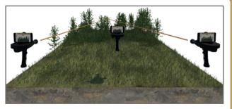
Bei der Triangulation (oder Kreuzpeilung) werden zwei oder mehr Punkte zur Zielbestimmung verwendet.
