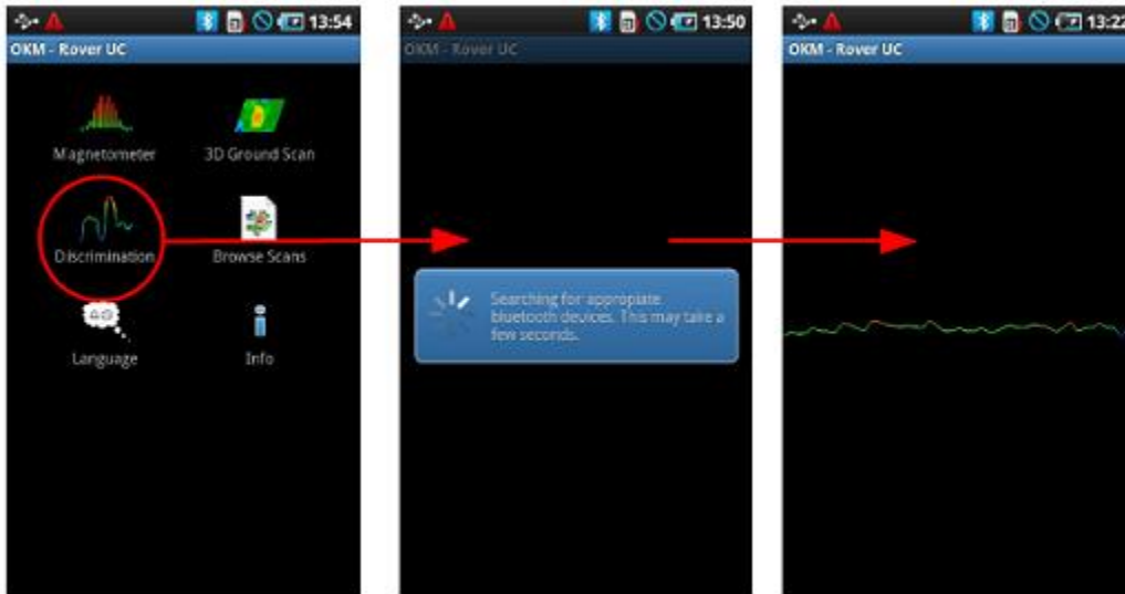
Figura 7.12: Activación del modo de funcionamiento "discriminación"
