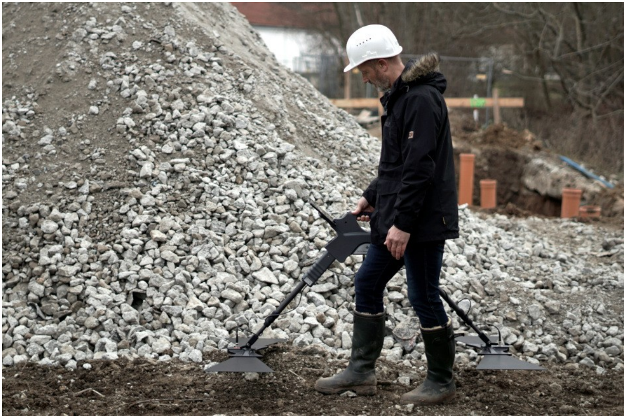
Figure 6.1 : Tenir le Gepard GPR avant de commencer le balayage
