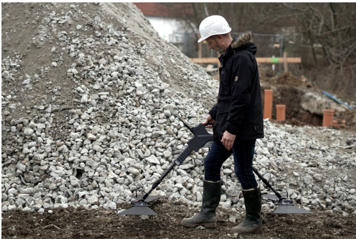
Figura 6.1: Sujeción del Gepard GPR antes de iniciar el escaneo
