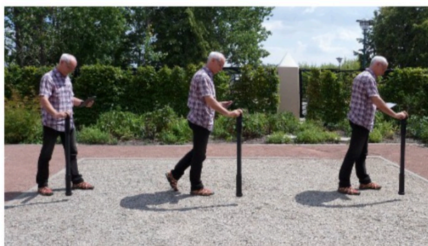
Figura 7.7: Escaneo en «Zigzag» en el modo «3D Ground Scan»
