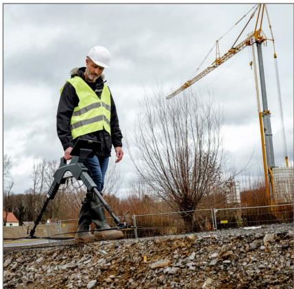
Das Gepard GPR verwendet ein ungerichtetes und ungeschirmtes Sendesystem, um eine maximale Messtiefe von bis zu 40 m zu erreichen. Dank Tablet mit Android App lässt sich das kompakte Bodenradar völlig unkompliziert von einem einzelnen Benutzer einsetzen.
