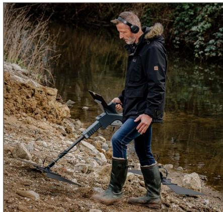
Dank der verstellbaren Teleskopgestänge lassen sich Bodenuntersuchungen optimieren. Die Schritt-für-Schritt-Konfiguration vereinfacht die Anwendung des Gepard GPR auf verschiedenen Bodentypen. Nach Auswahl der Eindringtiefe beginnt die geophysikalische Messung.
