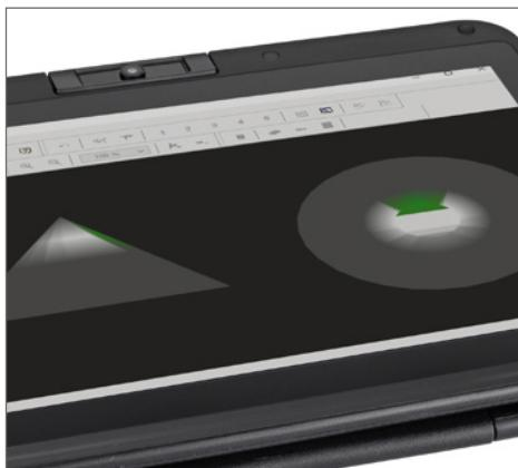
Fusion Professional Plus bietet die Spezialfunktion *Live Scan*: Der direkte „Blick“ in den Boden. Mit dieser Echtzeitmessung lassen sich unterirdische Objekte besonders schnell und flexibel lokalisieren. In horizontaler Ausrichtung werden detektierte Strukturen in Echtzeit durch unterschiedliche Farben dargestellt. In vertikaler Ausrichtung werden die Objekte als versinnbildlichtes Ultraschallbild angezeigt.
