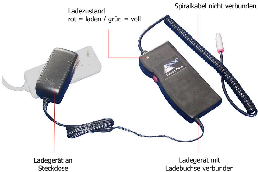
Während der Power Pack geladen wird, leuchtet die LED dauerhaft rot. Sobald die LED grün leuchtet, ist der Power Pack vollständig geladen und muss vom Ladegerät getrennt werden.
