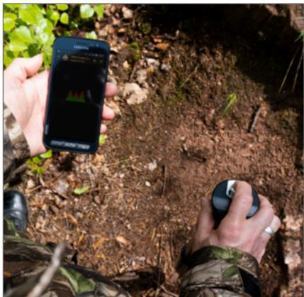
Mit der Betriebsart *Magnetometer* lassen sich ferromagnetische Objekte nahe der Oberfläche detektieren. Diese Funktion wird empfohlen, um das Messfeld vor dem Bodenscan von störenden Objekten zu befreien.
