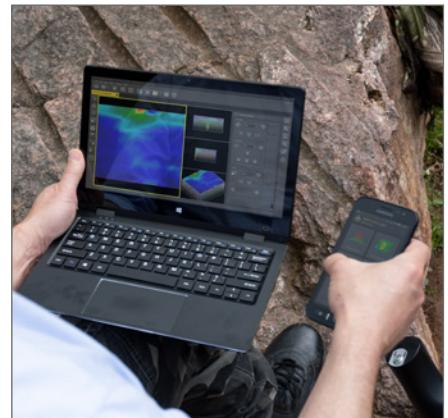
Nach Übertragung der Scandaten vom Smartphone auf das Notebook werden diese mithilfe der Software *Visualizer 3D Studio* in einer 3D-Grafik dargestellt. So können Position, Größe und Tiefe der gefundenen Objekte präziser bestimmt werden.
